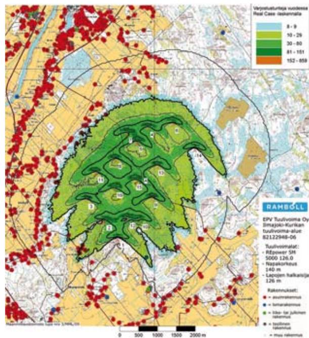
Kuva 14-15. Varjostuslaskelma hankevaihtoehdossa 2 tuulivoimaloiden napakorkeuden ollessa 140 metriä (Todellinen tilanne Real Case –laskelma)
