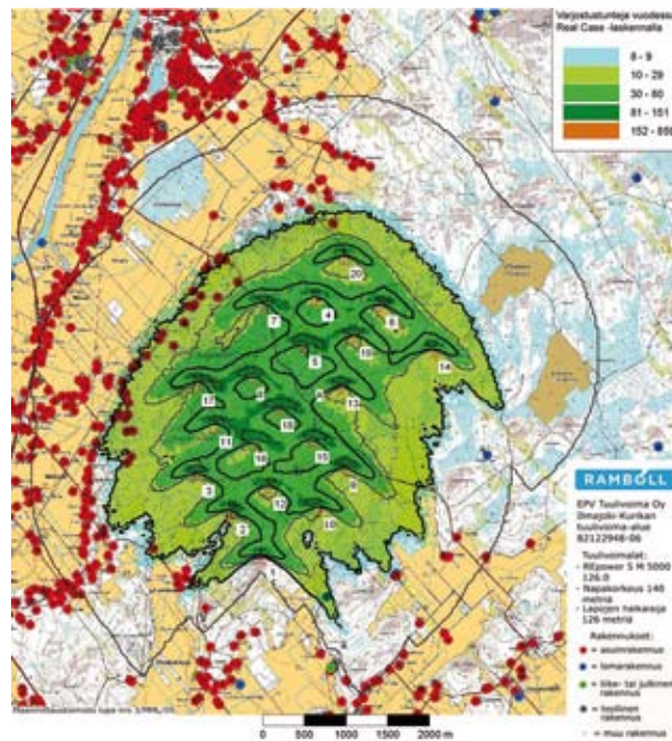
Kuva 14-13. Varjostuslaskelma hankevaihtoehdossa 1 tuulivoimaloiden napakorkeuden ollessa 140 metriä (Todellinen tilanne Real Case -laskelma)
