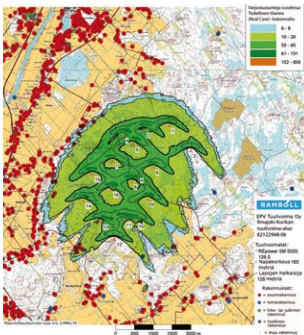
Kuva 14-16. Varjostuslaskelma hankevaihtoehdossa 2 tuulivoimaloiden napakorkeuden ollessa 160 metriä (Todellinen tilanne Real Case –laskelma)
