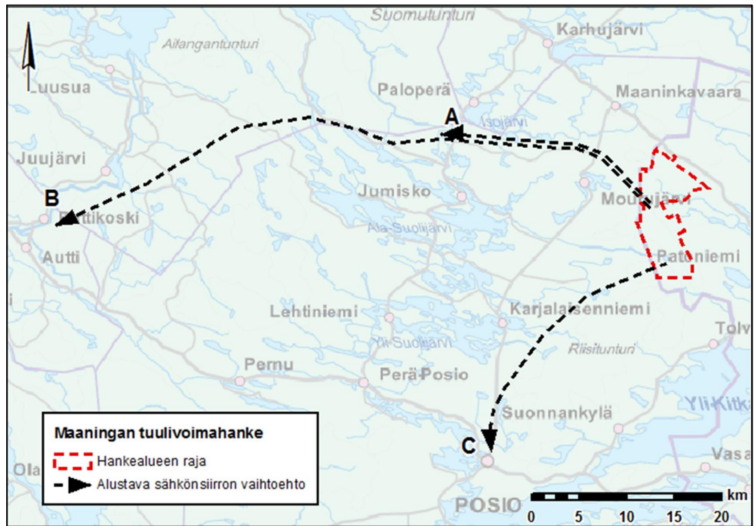
Kuva 12. Sähkönsiirron alustavat vaihtoehdot.
