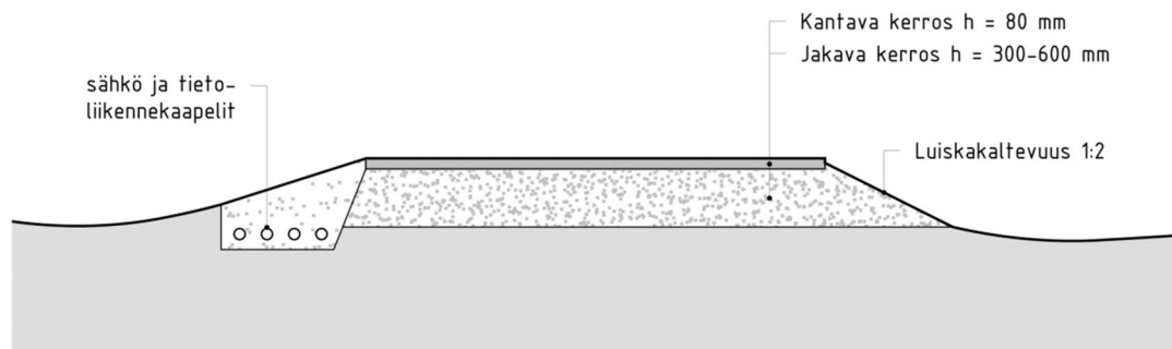
Periaatekuva uuden ja perusparannettavan tien rakenteesta.
