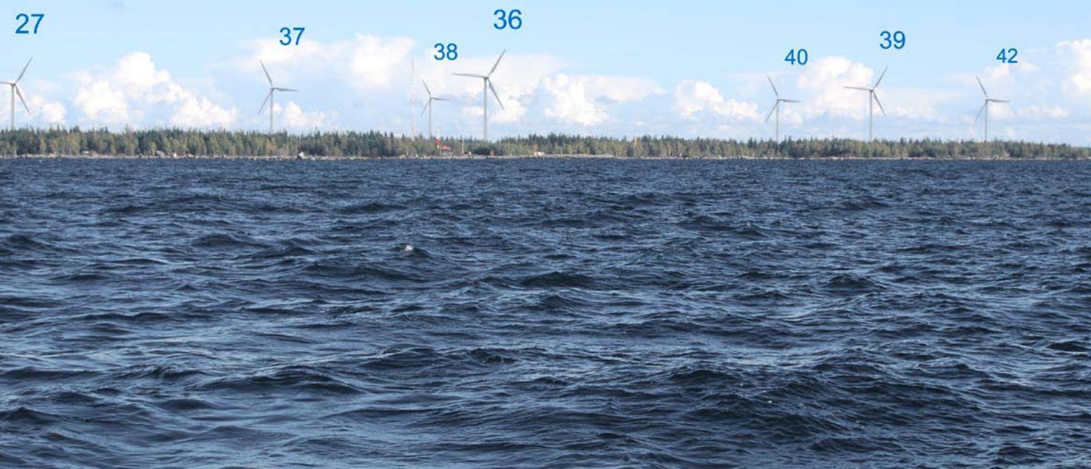
Figur 10-7 Visualisering från havsområdet utanför Replot. Bilden motsvarar ALT 3, tornhöjden är 125 meter och rotorns diameter 63 m. På bilden syns endast den sydligaste delen av vindkraftsparken.
